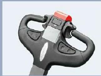
El timón modular es simple pero confiable y bonito, todas las piezas que contiene se pueden reemplazar por separado y todas las operaciones se pueden hacer fácilmente con una sola mano.
