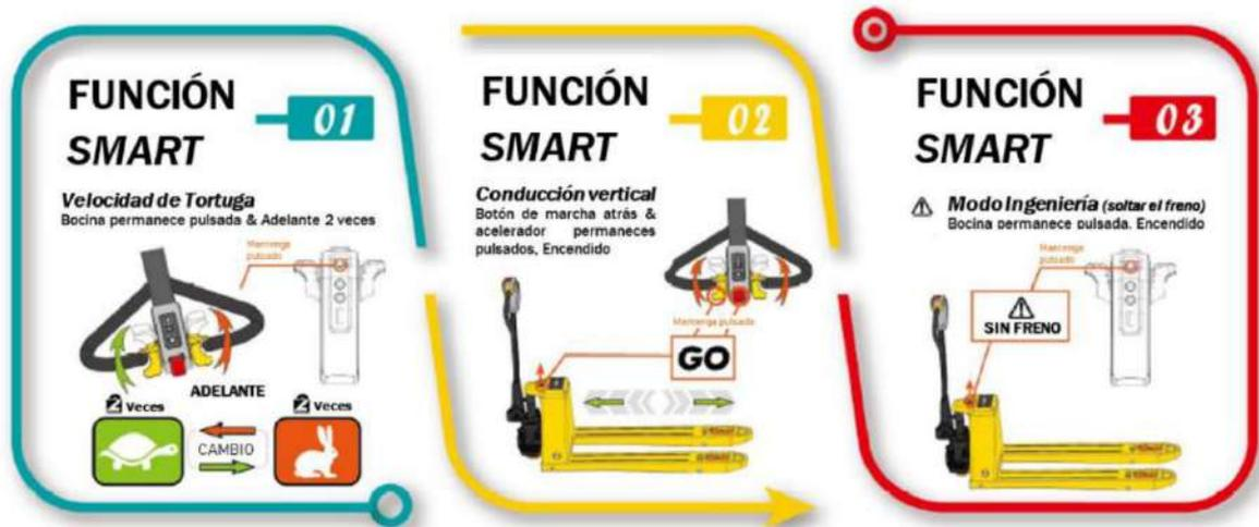
\*En modo timón vertical de la máquina se moverá cuando el timón opere en cualquier posición. Por favor, evite el mal funcionamiento.
