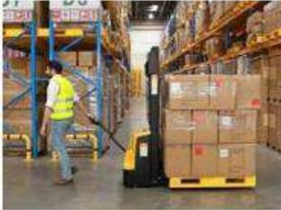
Permite al operador elegir distintos modos de velocidad en función de su experiencia y del entorno de trabajo específico.
